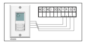
5.4.3 ELECTRICAL CONNECTION TO LITE-TOUCH CONSTRUCTO OR SIMPLE-TOUCH CONSTRUCTO MAIN WALL CONTROLS (K7 ERV, K8 HRV AND K10 HRV UNITS ONLY)
